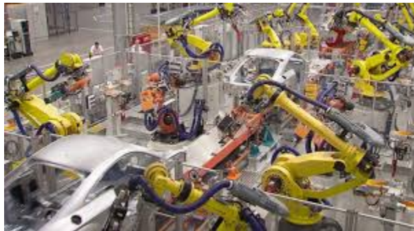
Gambar 3 Pekerjaan merakit mobil oleh robot
